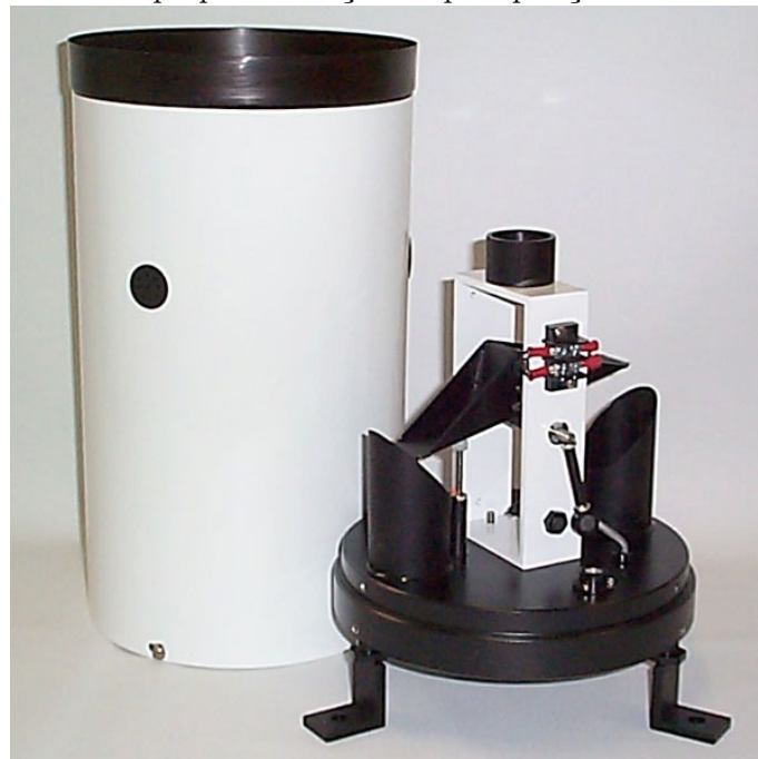
Figura 2.6 - Pluviômetro do tipo Tipping Bucket (modelo 260-2500), utilizado em experimentos de campo para medição da precipitação.
